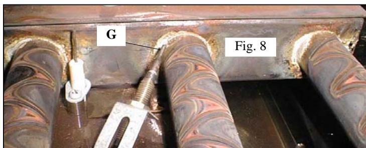
**(FR)** Si le brûleur s'éteint, après avoir maintenu enfoncée à fond la manette une vingtaine de secondes; vérifier : Le serrage (modéré) de la tête magnétique sur le robinet, que la pointe du thermocouple **G** soit bien léchée par la flamme (fig. 8) et le bon état de propreté des thermocouples et têtes magnétiques.
