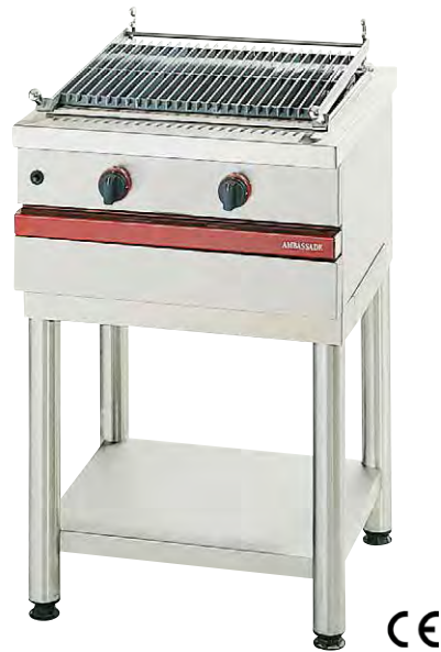
CSG 620 CKG L 600 - P 650 - H 900 Gril Gaz à pierres de lave • Surface de cuisson : 490 x 410 mm. • Puissance du brûleur gaz : 12 kW. • Allumage électrique - Alimentation 230 V. • Sécurité par thermocouple. • Grille de cuisson à barreaux plats, amovible. • Réglage de hauteur sur support arrière. • Livré avec un sachet de 6 kg de pierres de lave. • Livré sans support (voir page 50). CSG 620 CKG H.T. 2 490 €
