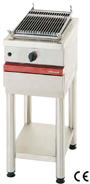
CSG 410 CKG L 400 - P 650 - H 900 Gril Gaz à pierres de lave • Surface de cuisson : 260 x 470 mm. • Puissance du brûleur gaz : 6 kW. • Allumage électrique - Alimentation 230 V. • Sécurité par thermocouple. • Grille de cuisson à barreaux plats, amovible. • Réglage de hauteur sur support arrière. • Livré avec un sachet de 3 kg de pierres de lave. • Livré sans support (voir page 50). CSG 410 CKG H.T. 1 790 €
