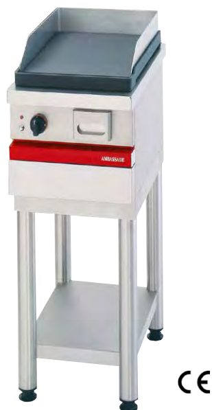
CSG 410 GL L 400 - P 650 - H 900 Gril fonte émaillée lisse gaz • Surface de cuisson : 350 x 490 mm (17 dm²). • Puissance gaz totale: 6 kW. • Robinet gaz débit nominal et débit réduit. • Sécurité par thermocouple. • Allumage électrique par poussoir sur bandeau. • Alimentation 230 V. • Livré sans support (voir page 50). CSG 410 GL H.T. 1 480 €
