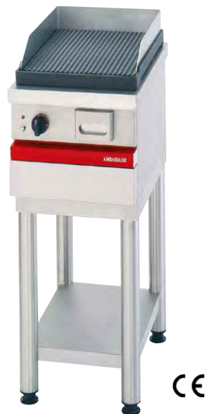
CSG 410 GR L 400 - P 650 - H 900 Gril fonte émaillée nervurée gaz • Surface de cuisson : 350 x 490 mm (17 dm²). • Puissance gaz totale: 6 kW. • Robinet gaz débit nominal et débit réduit. • Sécurité par thermocouple. • Allumage électrique par poussoir sur bandeau. • Alimentation 230 V. • Livré sans support (voir page 50). CSG 410 GR H.T. 1 420 €
