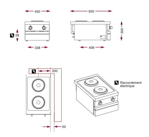
À fonction équivalente, les modules présentent les mêmes caractéristiques techniques et les mêmes performances que les modules sur armoires. Ils sont conçus pour être posés sur des supports adaptés en tube inox, mais ils peuvent tout aussi bien être installés sur des plans en inox ou encore sur un support carrelé.
