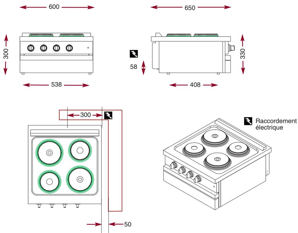
À fonction équivalente, les modules présentent les mêmes caractéristiques techniques et les mêmes performances que les modules sur armoires. Ils sont conçus pour être posés sur des supports adaptés en tube inox, mais ils peuvent tout aussi bien être installés sur des plans en inox ou encore sur un support carrelé.
