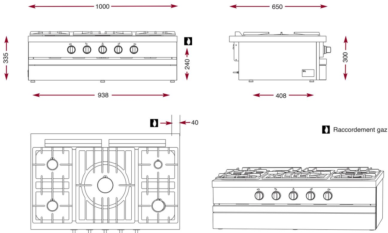
À fonction équivalente, les modules présentent les mêmes caractéristiques techniques et les mêmes performances que les modules sur armoires. Ils sont conçus pour être posés sur des supports adaptés en tube inox, mais ils peuvent tout aussi bien être installés sur des plans en inox ou encore sur un support carrelé.
