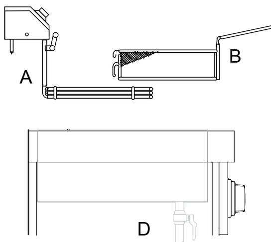
**Décantation** : Après chaque service, il est conseillé de décanter la zone froide de l'eau quelle contient, en ouvrant légèrement la vanne D, jusqu'à écoulement de l'huile, après avoir pris soin de positionner un récipient sous celle-ci.
