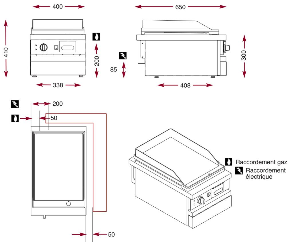
À fonction équivalente, les modules présentent les mêmes caractéristiques techniques et les mêmes performances que les modules sur armoires. Ils sont conçus pour être posés sur des supports adaptés en tube inox, mais ils peuvent tout aussi bien être installés sur des plans en inox ou encore sur un support carrelé.
