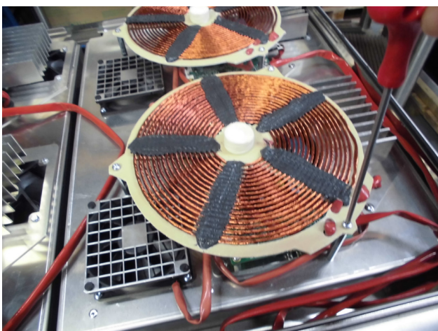
Retirer les 3 vis qui maintiennent l'inducteur.
