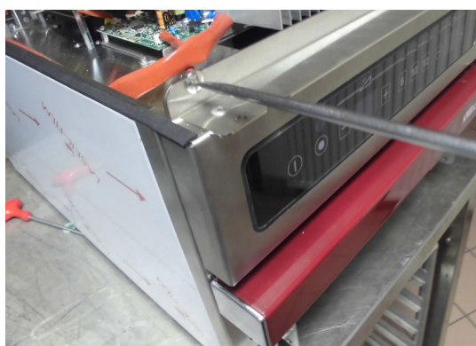
Retirer les 2 vis supérieures.
