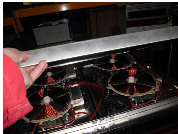
Déposer le dessus vitrocéramique.
