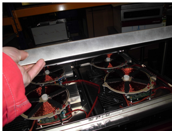
Déposer le dessus vitrocéramique.
