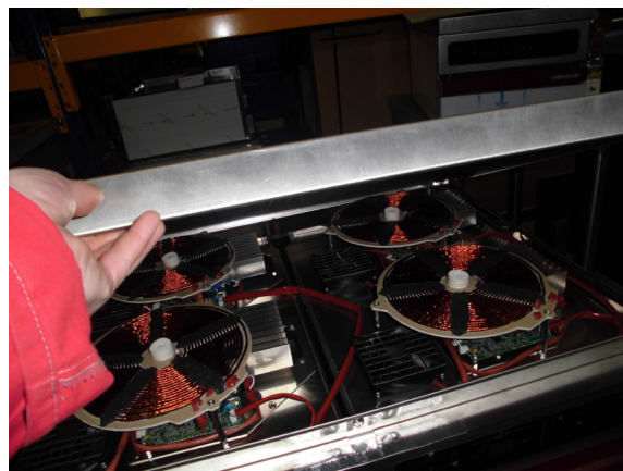
Déposer le dessus vitrocéramique.
