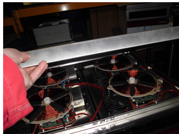
Déposer le dessus vitrocéramique.
