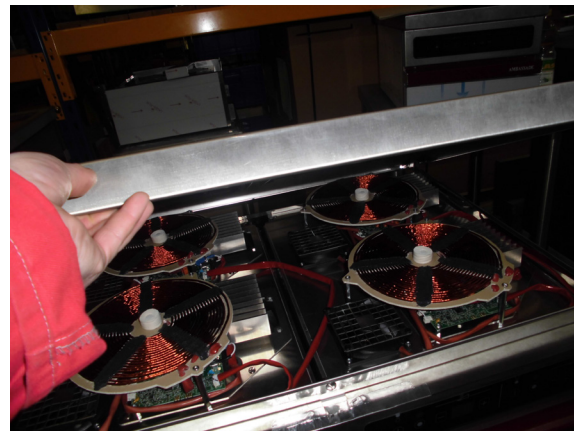
Déposer le dessus vitrocéramique.
