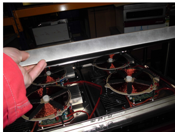
Déposer le dessus vitrocéramique.
