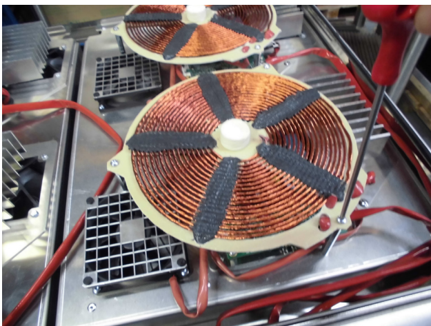
Retirer les 3 vis qui maintiennent l'inducteur.
