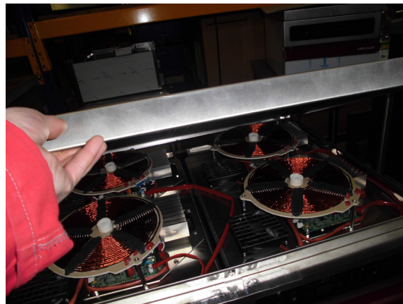
Déposer le dessus vitrocéramique.
