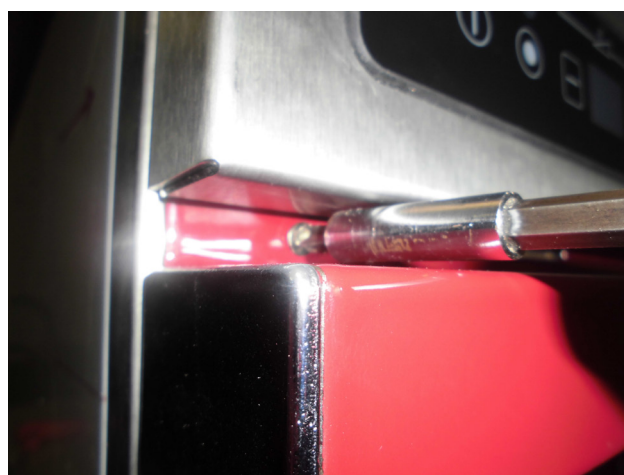
Retirer les 2 vis qui se trouvent entre le bandeau et le bandeau d'aération.
